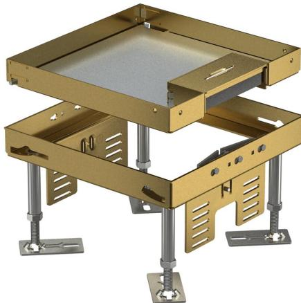
Cassetta livellabile di dimensione nominale 4 con uscita cavo per il montaggio di apparecchi di installazione in pavimenti trattati a secco in ambienti interni. Cassetta livellabile con uscita cavo a 2 vie. È possibile installare 2 piastre di copertura APMT2. Per il montaggio di 2 supporti universali UT3 per 4 apparecchi di installazione singoli con anello/staffa di supporto o 6 apparecchi Modul 45.
