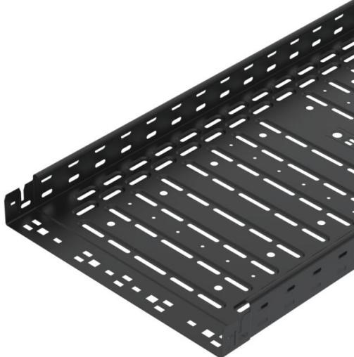
Chemin de câbles avec système de fixation rapide intégré Surface galvanisée en bande, avec revêtement par poudre en noir profond (RAL 9005). Perforation latérale continue de 7 x 20 mm pour l'installation d'éléments de montage et de raccordement supplémentaires. Avec perforation centrale de 11 mm au fond pour la suspension directe par tige filetée. Longueur utile 3000 mm. Atténuation magnétique du blindage sans couvercle 20 dB, avec couvercle 50 dB.
