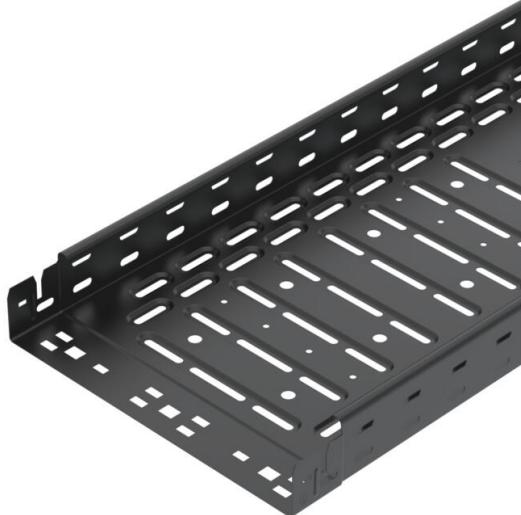
Kabelrinne mit integriertem Schnellbefestigungssystem. Bandverzinkte Oberfläche, pulverbeschichtet in tiefschwarz (RAL 9005). Durchgängige Seitenlochung von 7 x 20 mm für die Installation zusätzlicher Verbindungs- und Montagebauteile. Mit 11-mm-Lochung im Boden für die direkte Gewindestangenabhängung. Nutzlänge 3.000 mm.
