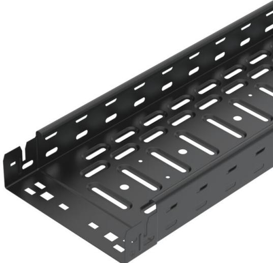
Chemin de câbles avec système de fixation rapide intégré Surface galvanisée en bande, avec revêtement par poudre en noir profond (RAL 9005). Perforation latérale continue de 7 x 20 mm pour l'installation d'éléments de montage et de raccordement supplémentaires. Avec perforation centrale de 11 mm au fond pour la suspension directe par tige filetée. Longueur utile 3000 mm. Atténuation magnétique du blindage sans couvercle 20 dB, avec couvercle 50 dB.
