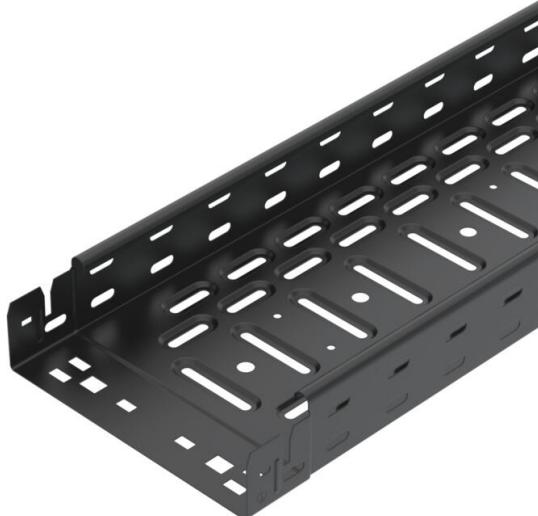
Kabelrinne mit integriertem Schnellbefestigungssystem. Bandverzinkte Oberfläche, pulverbeschichtet in tiefschwarz (RAL 9005). Durchgängige Seitenlochung von 7 x 20 mm für die Installation zusätzlicher Verbindungs- und Montagebauteile. Mit 11-mm-Lochung im Boden für die direkte Gewindestangenabhängung. Nutzlänge 3.000 mm.
