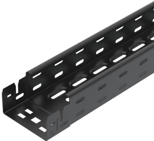
Kabelrinne mit integriertem Schnellbefestigungssystem. Bandverzinkte Oberfläche, pulverbeschichtet in tiefschwarz (RAL 9005). Durchgängige Seitenlochung von 7 x 20 mm für die Installation zusätzlicher Verbindungs- und Montagebauteile. Mit 11-mm-Lochung im Boden für die direkte Gewindestangenabhängung. Nutzlänge 3.000 mm.
