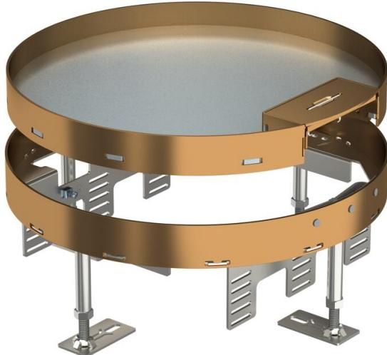
Nivellierbare Kassette der Nenngröße R9 mit Schnurauslass für den Einbau von Installationsgeräten in trocken gepflegten Fußböden im Innenbereich. Nivellierbare Kassette mit Schnurauslass, 3-zügig. Es können 3 Abdeckplatten APMT5 installiert werden. Für den Einbau von 3 Universalträgern UT4 für 9 Einzel-Installationsgeräte mit Tragering/Tragebügel oder 12 Modul 45-Geräte.
