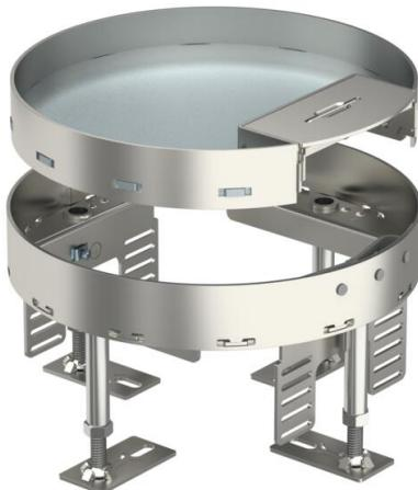
Cassetta livellabile con uscita cavo di dimensione nominale R4 per il montaggio di apparecchi di installazione in pavimenti trattati a secco in ambienti interni. Cassetta livellabile con uscita cavo a 2 vie. È possibile installare 2 piastre di copertura APMT2. Per il montaggio di 2 supporti universali UT3 per 4 apparecchi di installazione singoli con anello/staffa di supporto o 6 apparecchi Modul 45.
