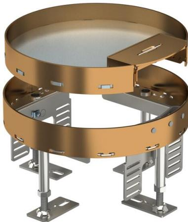
Nivellierbare Kassette der Nenngröße R4 mit Schnurauslass für den Einbau von Installationsgeräten in trocken gepflegten Fußböden im Innenbereich. Nivellierbare Kassette mit Schnurauslass, 2-zügig. Es können 2 Abdeckplatten APMT2 installiert werden. Für den Einbau von 2 Universalträgern UT3 für 4 Einzel-Installationsgeräte mit Tragering/Tragebügel oder 6 Modul 45-Geräte.
