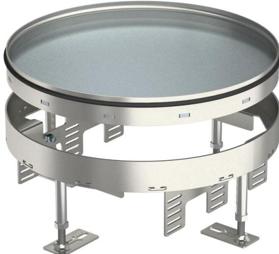
Cassetta tonda per carichi pesanti, "cieca", di dimensioni nominali R9, per la realizzazione di un'apertura di ispezione in sistemi di condotti, in pavimenti doppi e con intercapedini e in pavimenti trattati a secco, umido o bagnato in ambienti interni. Classe di carico 2 fino a 20 kN. Adatto solo per pavimenti lisci.
