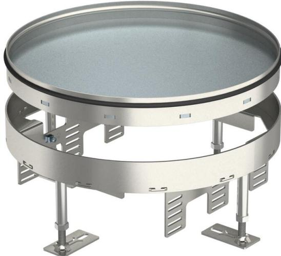
Runde Kassette Schwerlast "blind" in Nenngröße R9 für die Herstellung einer Revisionsöffnung in Kanalsystemen, Doppel- und Hohlböden, in trocken oder nass gepflegten Fußböden im Innenbereich. Belastungsklasse 2 bis 20 kN. Nur für glatte Bodenbeläge geeignet.
