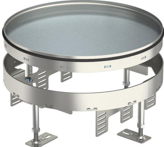
Cassette ronde pleine pour charges lourdes de taille nominale R9 pour la réalisation d'une trappe d'inspection dans les systèmes de goulottes, les faux-planchers et les planchers creux, dans des planchers nettoyés à l'eau ou à sec en intérieur. Classe de charge 2 jusqu'à 20 kN. Convient uniquement aux revêtements de sol lisses.
