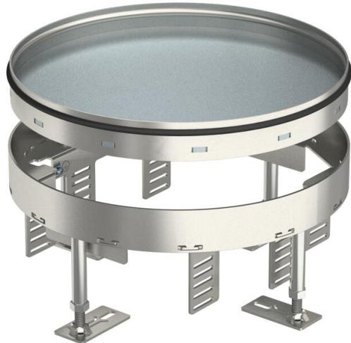
Cassette ronde pleine pour charges lourdes de taille nominale R7 pour la réalisation d'une trappe d'inspection dans les systèmes de goulottes, les faux-planchers et les planchers creux, dans des planchers nettoyés à l'eau ou à sec en intérieur. Classe de charge 2 jusqu'à 20 kN. Convient uniquement aux revêtements de sol lisses.
