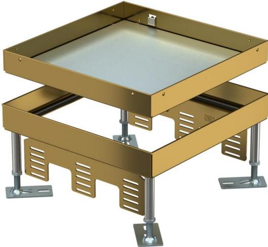
Cassetta livellabile "cieca" quadrata di dimensione nominale 9, per creare un'apertura d'ispezione; da installare nel sistema di condotti in pavimenti sopraelevati e con intercapedini, in pavimenti trattati a secco o umido in ambienti interni. Installazione semplificata e durabilità nel tempo. Per il montaggio di 3 supporti universali UT4 per 9 apparecchi di installazione singoli con anello/staffa di supporto o 12 apparecchi Modul 45®. È possibile installare 3 coperture APMT5.
