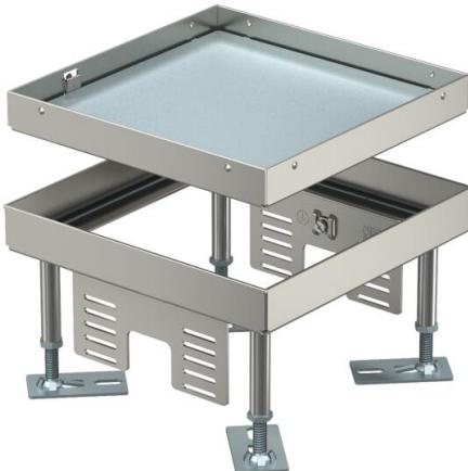
Cassetta quadrata per carichi pesanti "cieca" livellabile di dimensione nominale 4 per apertura d'ispezione. Montaggio nel sistema di condotti in pavimenti sopraelevati e con intercapedini, in pavimenti lavati a secco o con lavaggio bagnato in ambienti interni. Box portapparecchi 14 moduli da ordinare separatamente. Installazione semplificata e durabilità nel tempo.
