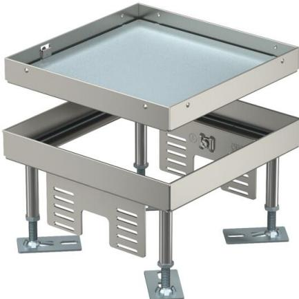
Cassette carrée pleine pour charges lourdes réglable en hauteur de taille nominale 4 pour la réalisation d'une trappe d'inspection. Montage dans les systèmes de goulottes, les faux-planchers et les planchers creux, dans des planchers nettoyés à l'eau ou à sec en intérieur. Classe de charge 1 jusqu'à 10 kN. Convient uniquement aux revêtements de sol lisses.
