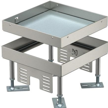
Cassette carrée pleine réglable en hauteur de taille nominale 4 pour la réalisation d'une trappe d'inspection. Montage dans les systèmes de goulottes, les faux-planchers et les planchers creux, dans des planchers nettoyés à l'eau ou à sec en intérieur. Convient uniquement aux revêtements de sol lisses. Indice de protection : IP X5.
