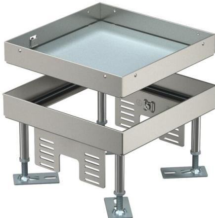
Nivellierbare quadratische Kassette "blind" für die Herstellung einer Revisionsöffnung der Nenngröße 4. Einbau in Kanalsystemen, Doppel- und Hohlböden in trocken oder nass gepflegten Fußböden im Innenbereich. Nur für glatte Bodenbeläge geeignet. Schutzklasse: IP X5.
