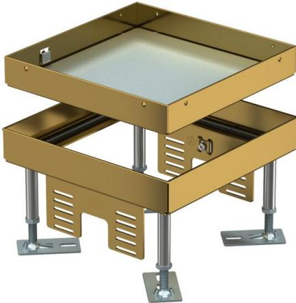
Cassetta livellabile "cieca" quadrata di dimensione nominale 4, per creare un'apertura d'ispezione; da installare nel sistema di condotti in pavimenti sopraelevati e con intercapedini, in pavimenti trattati a secco o umido in ambienti interni. Adatto solo per pavimenti lisci.
