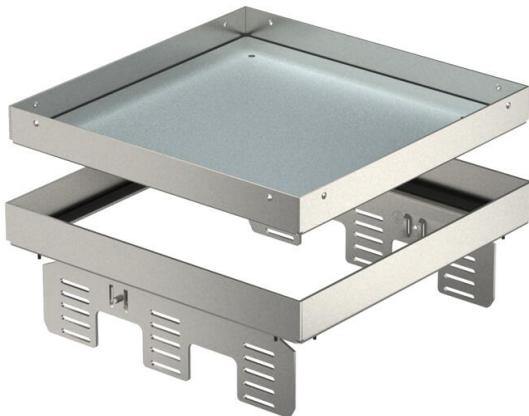
Nivellierbare und vom Fußboden entkoppelte Kassette "blind" für die Herstellung einer Revisionsöffnung der Nenngröße 9 in trocken oder nass gepflegten Fußböden im Innenbereich, zur Montage in Unterflurdosen UZD250 oder UZD350, jeweils in Verbindung mit einem Montagedeckel DUG./.9 oder in UGD250-3/9 oder UGD350-3/9. Die Montage erfolgt mittels Nivellierwinkel (separat bestellen) im Aluminium-Rahmenprofil der Unterflurdosen. Nur für glatte Bodenbeläge geeignet.
