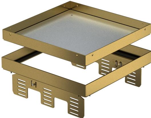
Nivellierbare und vom Fußboden entkoppelte Kassette "blind" für die Herstellung einer Revisionsöffnung der Nenngröße 9 in trocken oder nass gepflegten Fußböden im Innenbereich, zur Montage in Unterflurtdosen UZD250 oder UZD350, jeweils in Verbindung mit einem Montagedeckel DUG./9 oder in UGD250-3/9 oder UGD350-3/9. Die Montage erfolgt mittels Nivellierwinkel (separat bestellen) im Aluminium-Rahmenprofil der Unterflurtdosen. Nur für glatte Bodenbeläge geeignet.
