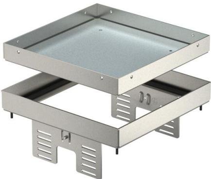
Nivellierbare und vom Fußboden entkoppelte Kassette "blind" für die Herstellung einer Revisionsöffnung der Nenngröße 4 in trocken oder nass gepflegten Fußböden im Innenbereich, zur Montage in Unterflurdosen UZD250 oder UZD350, jeweils in Verbindung mit einem Montagedeckel DUG./4 oder in UGD250-3/4 oder UGD350-3/4. Die Montage erfolgt mittels Nivellierwinkel (separat bestellen) im Aluminium-Rahmenprofil der Unterflurdosen. Nur für glatte Bodenbeläge geeignet.
