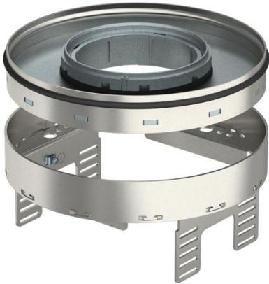
Cassette réglable en hauteur et découpée par rapport au plancher de taille nominale R4, pour Tubus, pour le montage d'appareillages dans des planchers nettoyés à sec ou à l'eau en intérieur, pour le montage dans des boîtes de tirage UZD250-3 ou UZD350-3 en association avec un couvercle de montage DUG.R4 ou dans des boîtes de tirage UGD250-3R4 ou UGD350-3R4. Le montage s'effectue à l'aide d'équerres de nivellation (à commander séparément) dans le profilé de cadre en aluminium des boîtes de sol.
