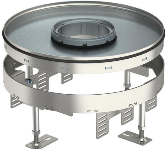
Cassette ronde pour charges lourdes pour Tubus de taille nominale R9 pour le montage d'appareillages dans des systèmes de goulottes, des faux-planchers et des planchers creux, dans des planchers nettoyés à l'eau ou à sec en intérieur. Classe de charge 2 jusqu'à 20 kN.
