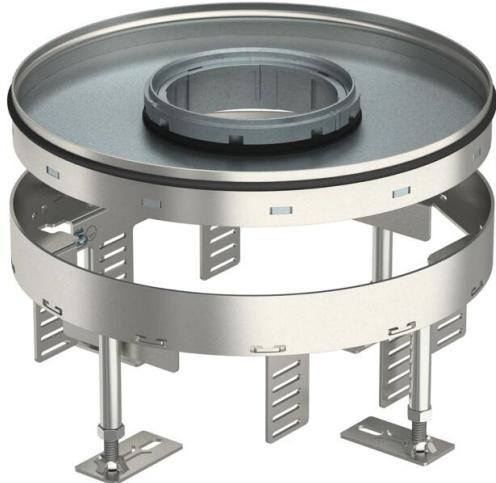
Cassetta tonda per carichi pesanti per Tubus di dimensione nominale R7 per l'installazione di accessori in sistemi di canalizzazione, pavimenti sopraelevati e intercedimenti, in pavimenti puliti a secco o a umido in ambienti interni. Classe di carico 2 fino a 20 kN.
