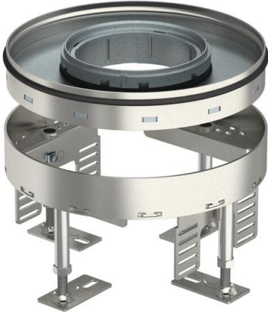
Cassetta tonda per carichi pesanti per Tubus di dimensione nominale R4 per l'installazione di accessori in sistemi di canalizzazione, pavimenti sopraelevati e intercapedini, in pavimenti puliti a secco o a umido in ambienti interni. Classe di carico 2 fino a 20 kN.
