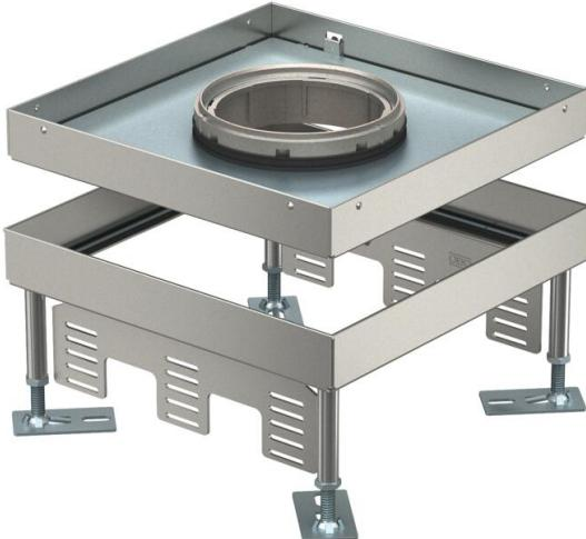
Cassetta livellabile quadrata per Tubus di dimensione nominale 9 per carichi pesanti, per il montaggio di apparecchi d'installazione nel sistema di condotti in pavimenti sopraelevati e con intercapedini, in pavimenti lavati a secco o con lavaggio bagnato. Box portapparecchi 14 moduli da ordinare separatamente.
