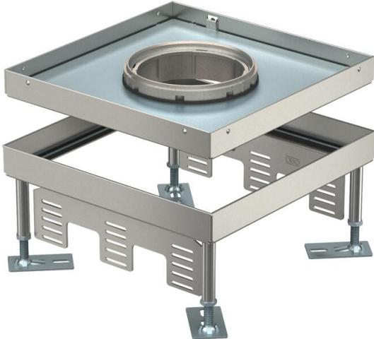
Cassette carrée pour charges lourdes réglable en hauteur pour tube de taille nominale 9 pour le montage d'appareillages dans des systèmes de goulottes, des faux-planchers et des planchers creux, dans des planchers nettoyés à l'eau ou à sec en intérieur. Classe de charge 1 jusqu'à 10 kN.
