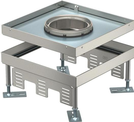
Nivellierbare quadratische Kassette Schwerlast für Tubus der Nenngröße 9 für den Einbau von Installationsgeräten in Kanalsystemen, Doppel- und Hohlböden in trocken oder nass gepflegten Fußböden im Innenbereich. Belastungsklasse 1 bis 10 kN.
