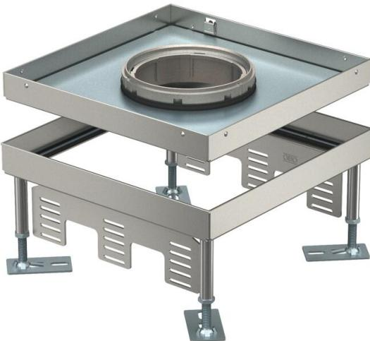
Cassette carrée réglable en hauteur pour tube de taille nominale 9 pour le montage d'appareillages dans des systèmes de goulottes, des faux-planchers et des planchers creux, dans des planchers nettoyés à l'eau ou à sec en intérieur. Convient uniquement pour des revêtements de sol lisses.
