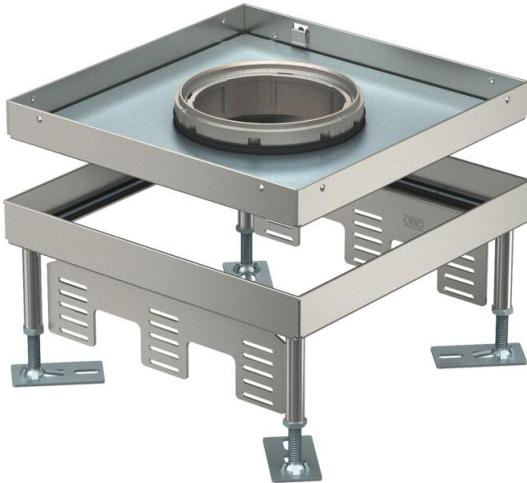
Nivellierbare quadratische Kassette für Tubus der Nenngröße 9 für den Einbau von Installationsgeräten in Kanalsystemen, Doppel- und Hohlböden in trocken oder nass gepflegten Fußböden im Innenbereich. Nur passend für glatte Bodenbeläge.
