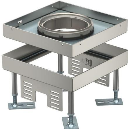
Cassette carrée pour charges lourdes réglable en hauteur pour tube de taille nominale 4 pour le montage d'appareillages dans des systèmes de goulottes, des faux-planchers et des planchers creux, dans des planchers nettoyés à l'eau ou à sec en intérieur. Classe de charge 1 jusqu'à 10 kN.
