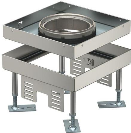
Cassette carrée réglable en hauteur pour tube de taille nominale 4 pour le montage d'appareillages dans des systèmes de goulottes, des faux-planchers et des planchers creux, dans des planchers nettoyés à l'eau ou à sec en intérieur. Indice de protection : IP X5.
