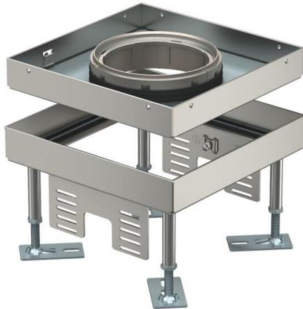
Nivellierbare quadratische Kassette für Tubus der Nenngröße 4 für den Einbau von Installationsgeräten in Kanalsystemen, Doppel- und Hohlböden in trocken oder nass gepflegten Fußböden im Innenbereich. Schutzklasse: IP X5. Für den Einbau von 2 Universalträgern UT3 für 4 Einzel-Installationsgeräte mit Tragering/Tragebügel oder 6 Modul 45®-Geräte. Es können 2 Abdeckplatten APMT2 installiert werden. Der Tubus ist nicht im Lieferumfang enthalten.
