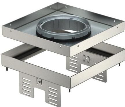
Nivellierbare und vom Fußboden entkoppelte Kassette der Nenngröße 4, für Tubus, für den Einbau von Installationsgeräten in trocken oder nass gepflegten Fußböden im Innenbereich, zur Montage in Unterfurtdosen UZD250 oder UZD350, jeweils in Verbindung mit einem Montagedeckel DUG../4 oder in UGD250-3/4 oder UGD350-3/4. Die Montage erfolgt mittels Nivellierwinkeln (separat bestellen) im Aluminium-Rahmenprofil der Unterfurtdosen.
