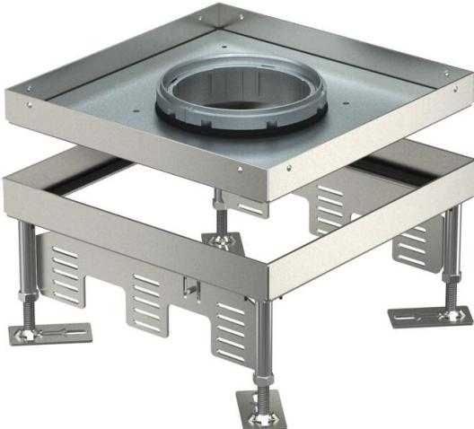
Cassette carrée pour charges lourdes pour Tubus de taille nominale 9 pour le montage d'appareillages dans des systèmes de goulottes, des faux-planchers et des planchers creux, dans des planchers nettoyés à l'eau ou à sec en intérieur. Classe de charge 1 jusqu'à 10 kN.
