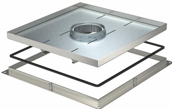
Rahmenkassette Schwerlast für Tubus für den Einbau von Installationsgeräten in der UZD350-3 in trocken oder nass gepflegten Fußböden im Innenbereich. Belastungsklasse 2 bis 20 kN. Der Tubus ist nicht im Lieferumfang enthalten.
