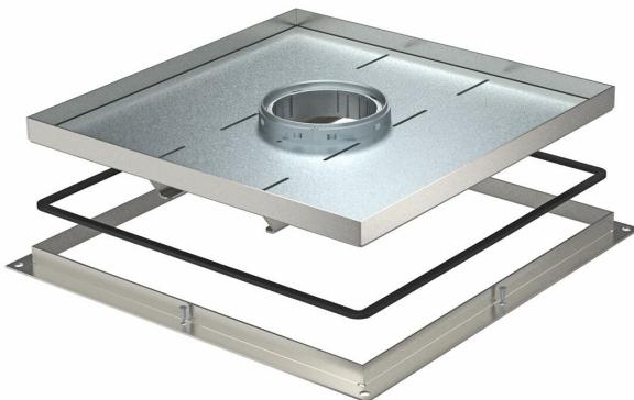
Rahmenkassette Schwerlast für Tubus für den Einbau von Installationsgeräten in der UZD350-3 in trocken oder nass gepflegten Fußböden im Innenbereich. Belastungsklasse 2 bis 20 kN. Der Tubus ist nicht im Lieferumfang enthalten. Rahmenkassette Schwerlast für Tubus für den Einbau von Installationsgeräten in der Unterflurdose UZD350-3 in trocken oder nass gepflegten Fußböden im Innenbereich. Belastungsklasse 2 bis 20 kN. Der Tubus ist nicht im Lieferumfang enthalten.
