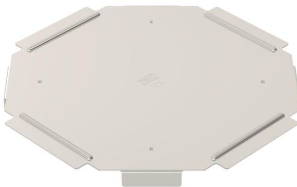
Couvercle pour pièce de forme croix pour chemins de câbles encliquetables et visssables en intérieur et en extérieur, pour protéger le câble contre les dommages et la saleté. Fixation par appui sur le couvercle pour chemin de câbles. Convient à toutes les hauteurs d'ailes.
