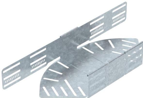
Winkelverstellbarer Bogen zum Erstellen einer horizontalen Abzweigung, Formteil für rast- und schraubbare Kabelrinnen Seitenhöhe 85 mm. Einstellbarer Winkel 0 - 90°. Schraubenlose Montage mit Doppelklemmen oder Schraubverbindung mit Flachrundschrauben FRS und Kombimuttern M6. Einsetzbar im Innen- und Außenbereich. Befestigungsmaterial muss separat bestellt werden.
