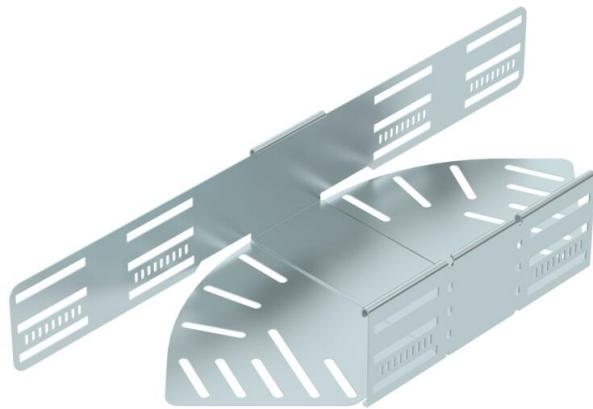
Winkelverstellbarer Bogen zum Erstellen einer horizontalen Abzweigung, Formteil für rast- und schraubbare Kabelrinnen Seitenhöhe 85 mm. Einstellbarer Winkel 0 - 90°. Schraubenlose Montage mit Doppelklemmen oder Schraubverbindung mit Flachrundschrauben FRS und Kombimuttern M6. Einsetzbar im Innenbereich. Befestigungsmaterial muss separat bestellt werden.
