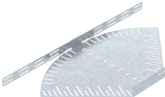
Winkelverstellbarer Bogen zum Erstellen einer horizontalen Abzweigung, Formteil für rast- und schraubbare Kabelrinnen Seitenhöhe 60 mm. Einstellbarer Winkel 0 - 90°. Schraubenlose Montage mit Doppelklemmen oder Schraubverbindung mit Flachrundschrauben FRS und Kombimuttern M6. Einsetzbar im Innen- und Außenbereich. Befestigungsmaterial muss separat bestellt werden.
