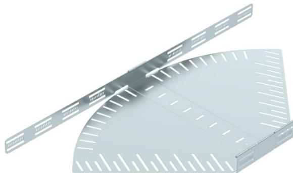
Winkelverstellbarer Bogen zum Erstellen einer horizontalen Abzweigung, Formteil für rast- und schraubbare Kabelrinnen Seitenhöhe 60 mm. Einstellbarer Winkel 0 - 90°. Schraubenlose Montage mit Doppelklemmen oder Schraubverbindung mit Flachrundschrauben FRS und Kombimuttern M6. Einsetzbar im Innenbereich. Befestigungsmaterial muss separat bestellt werden.
