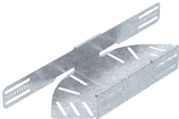
Winkelverstellbarer Bogen zum Erstellen einer horizontalen Abzweigung, Formteil für rast- und schraubbare Kabelrinnen Seitenhöhe 60 mm. Einstellbarer Winkel 0 - 90°. Schraubenlose Montage mit Doppelklemmen oder Schraubverbindung mit Flachrundschrauben FRS und Kombimuttern M6. Einsetzbar im Innen- und Außenbereich. Befestigungsmaterial muss separat bestellt werden.
