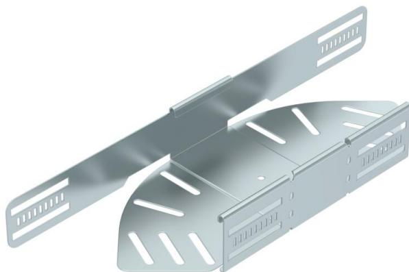
Winkelverstellbarer Bogen zum Erstellen einer horizontalen Abzweigung, Formteil für rast- und schraubbare Kabelrinnen Seitenhöhe 60 mm. Einstellbarer Winkel 0 - 90°. Schraubenlose Montage mit Doppelklemmen oder Schraubverbindung mit Flachrundschrauben FRS und Kombimuttern M6. Einsetzbar im Innenbereich. Befestigungsmaterial muss separat bestellt werden.
