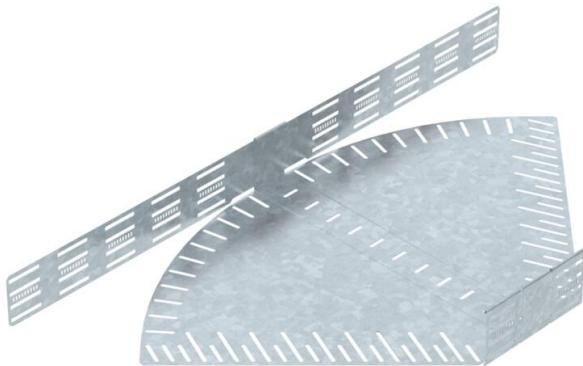
Winkelverstellbarer Bogen zum Erstellen einer horizontalen Abzweigung, Formteil für rast- und schraubbare Kabelrinnen Seitenhöhe 110 mm. Einstellbarer Winkel 0 - 90°. Schraubenlose Montage mit Doppelklemmen oder Schraubverbindung mit Flachrundschrauben FRS und Kombimuttern M6. Einsetzbar im Innen- und Außenbereich. Befestigungsmaterial muss separat bestellt werden.
