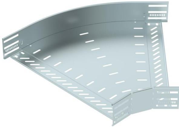
45°-Bogen zum Erstellen einer horizontalen Abzweigung, Formteil für rast- und schraubbare Kabelrinnen Seitenhöhe 85 mm. Schraubenlose Montage mit Doppelklemmen oder Schraubverbindung mit Flachrundschrauben FRS und Kombimuttern M6. Einsetzbar im Innenbereich. Befestigungsmaterial muss separat bestellt werden.
