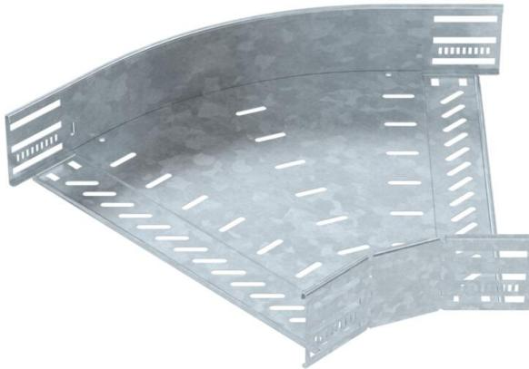
45°-Bogen zum Erstellen einer horizontalen Abzweigung, Formteil für rast- und schraubbare Kabelrinnen Seitenhöhe 85 mm. Schraubenlose Montage mit Doppelklemmen oder Schraubverbindung mit Flachrundschrauben FRS und Kombimuttern M6. Einsetzbar im Innen- und Außenbereich. Befestigungsmaterial muss separat bestellt werden.
