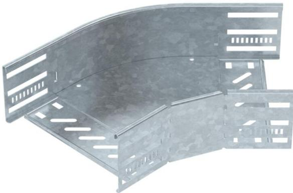
45°-Bogen zum Erstellen einer horizontalen Abzweigung, Formteil für rast- und schraubbare Kabelrinnen Seitenhöhe 85 mm. Schraubenlose Montage mit Doppelklemmen oder Schraubverbindung mit Flachrundschrauben FRS und Kombimuttern M6. Einsetzbar im Innen- und Außenbereich. Befestigungsmaterial muss separat bestellt werden.
