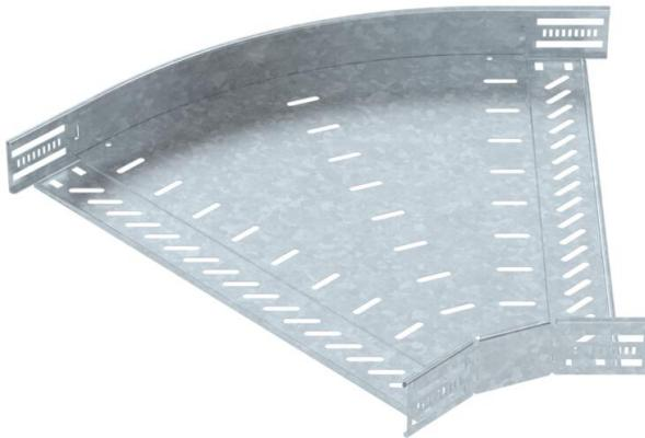
45°-Bogen zum Erstellen einer horizontalen Abzweigung, Formteil für rast- und schraubbare Kabelrinnen Seitenhöhe 60 mm. Schraubenlose Montage mit Doppelklemmen oder Schraubverbindung mit Flachrundschrauben FRS und Kombimuttern M6. Einsetzbar im Innen- und Außenbereich. Befestigungsmaterial muss separat bestellt werden.
